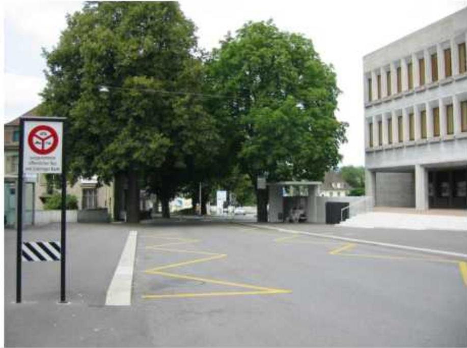
Abbildung 7: Beispiel Lenzburg, in Platz integrierte hohe Buskanten.
