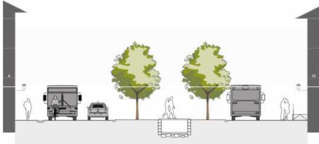
Abbildung 6: Querschnitt Alleebereich. Die Fahrbahn wird mit Rinnen oder niedrigen Randsteinen von den Seitenbereichen abgegrenzt, der Strassenraum wird von Fassade zu Fassade wahrgenommen.
